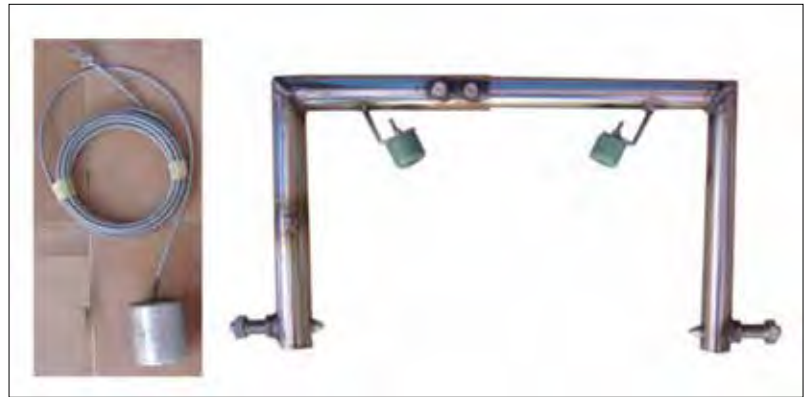
Fig. 6. Sistema di protezione catodica: anodo in lega di zinco e cavi elettrici (sinistra) e meccanismo di ancoraggio del sistema di protezione al cannone (destra) di Marettimo in Sicilia (© ICR).
